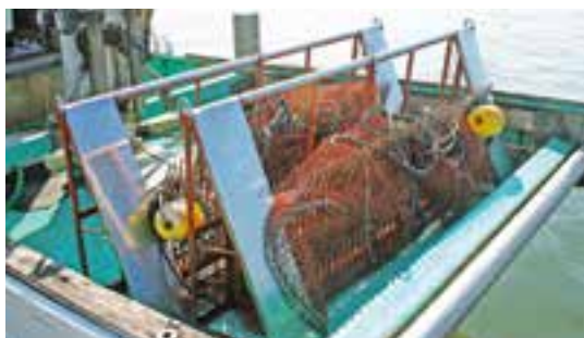
マンガと呼ばれる貝桁網。先端の尖った部分が砂を掘り起こす
