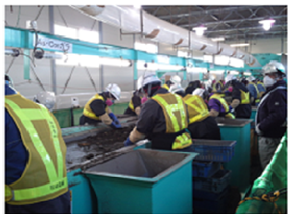
仮設処理施設内の手選別工程 (宮城県岩沼市、平成 25 年 2 月)
