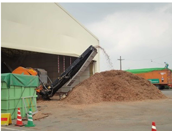
仮設処理施設での木くずの破碎 (熊本県熊本市、平成 29 年 7 月)
