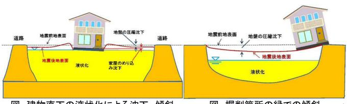
図 建物直下の液状化による沈下、傾斜
