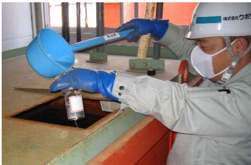
採水作業状況(水処理施設内)
