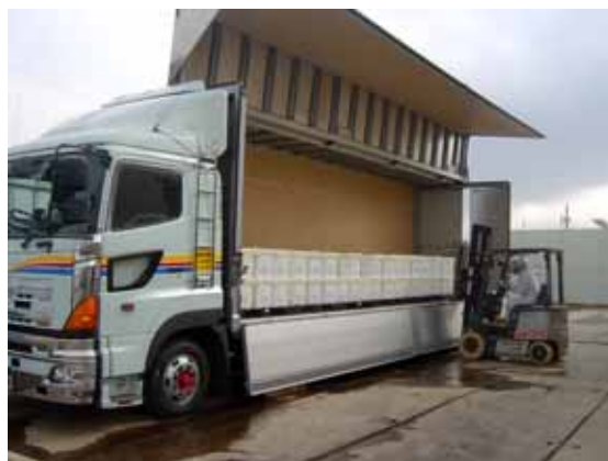
ウイング車へ密閉容器を 積み込む状況
