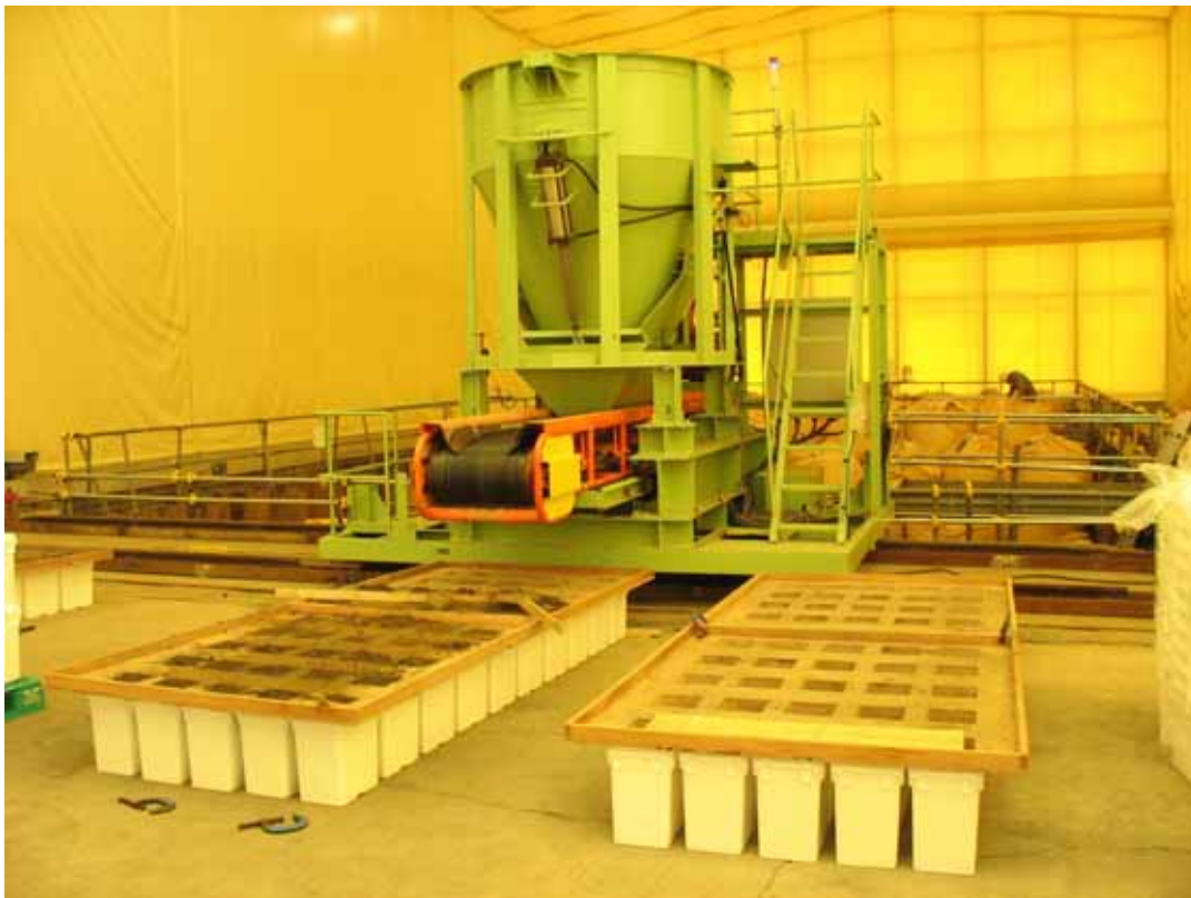
土壌詰め替え装置。中央奥の漏斗の中に汚染土壌を移し、ベルトコンベアから流れてくる土壌を密閉容器に充てんする。
