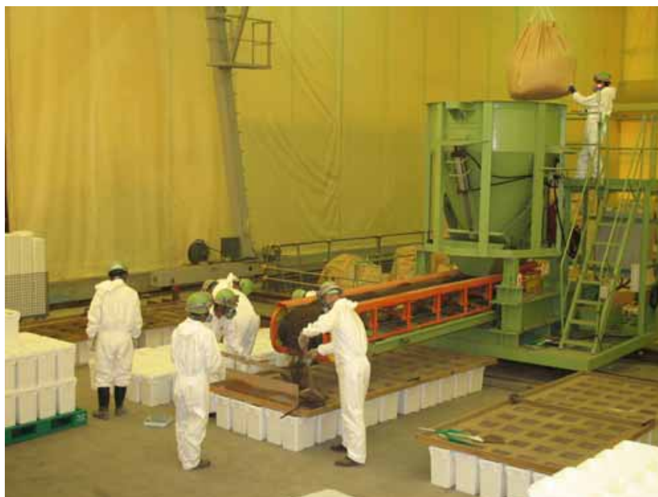
密閉容器への詰め替え作業
