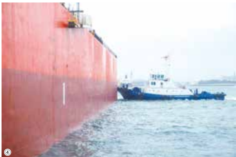
①「アイリス ヴィクトリア」に乗り込んだ水先人が鹿島港へ導く ②貨物船とタグボートをロープでつなぐ ③貨物船の進路を調整する ④貨物船を接岸させるため、水先人が指示を出し側面からタグボートで船体を押す ⑤任務を終えた水先人は、再びタグボートで陸へ送られる
