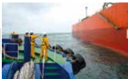
タグボートの船首のタイヤを船に接触させる
