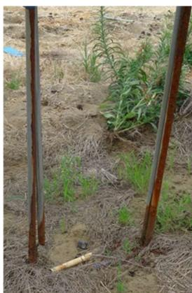
写真3 肩部の腐食
