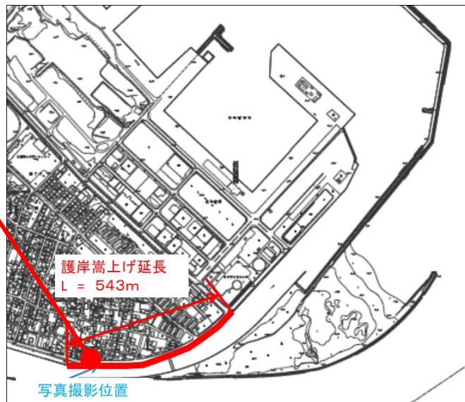
図 2-15 利根川河口部の護岸・堤防嵩上げ
