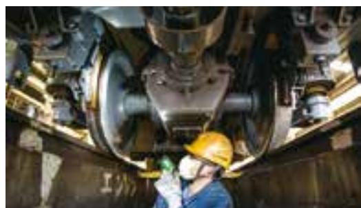
車両の下から点検整備
