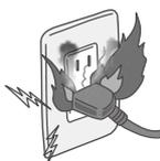
**事例2** 使用中の延長コードがソファの下敷きとなっており、断線が原因で発熱・出火
