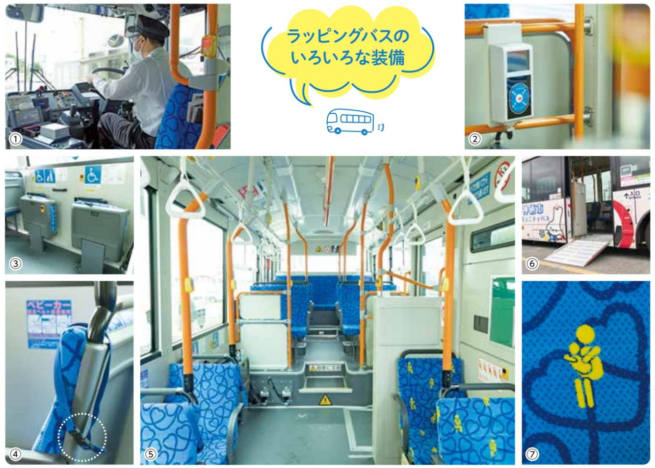
①運転席には計器がいっぱい ②交通系ICカードを利用できる ③座席を折りたたむと車いすを固定するスペースができる ④ベビーカーを固定するベルトを設置 ⑤窓が大きく明るい車内 ⑥車いすで乗り降りできるようスロープを完備 ⑦優先席はデザインで表示
