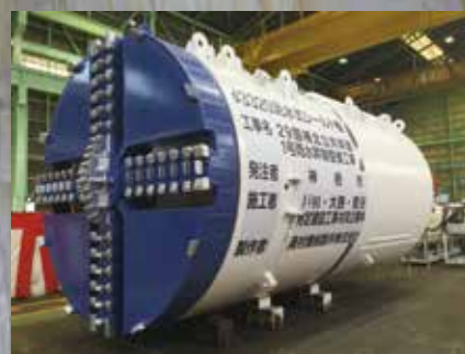
地下にトンネルを造るシールドマシン
