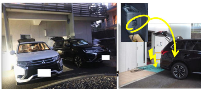
PHVからの給電：老人ホームで洗濯機・洗濯乾燥機に使用 出典：三菱自動車工業株式会社
