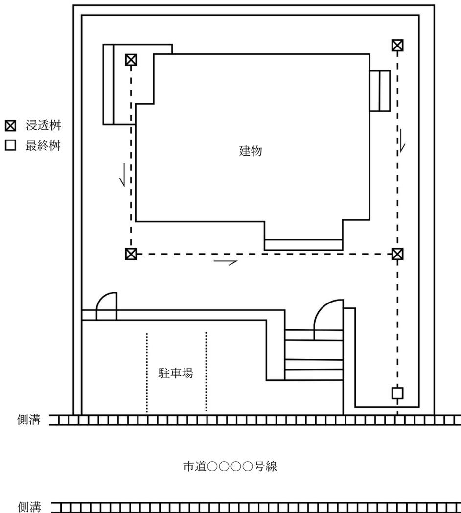
・雨水と汚水の経路は分けてください。そのうえでそれぞれの経路の下流側で合流させ 1 箇所での放流をお願いします。(汚水の浸透は NG)
