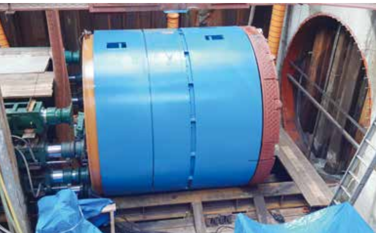
鹿島港に雨水を放流する「放流渠」整備で、地中を掘り進めた推進機
