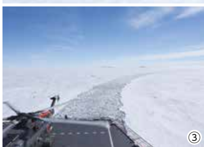
①見渡す限りの大雪原とペンギン ②③南極観測船「しらせ」。厚さ1.5mの氷を連続砕氷できる世界屈指の砕氷船 ④南極観測隊として活動中の小田さん
