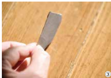
①下地研ぎは目の粗い砥石に変えながら研いでいく ②8種類の砥石を使い分ける ③工程に合わせて砥石の形も変える ④使い込まれた研ぎの道具 ⑤仕上げ研ぎは繊細な作業が続く ⑥砥石を砕いた粒子で刃をこする
