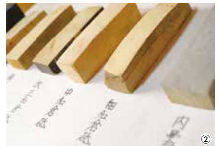
①下地研ぎは目の粗い砥石に変えながら研いでいく ②8種類の砥石を使い分ける ③工程に合わせて砥石の形も変える ④使い込まれた研ぎの道具 ⑤仕上げ研ぎは繊細な作業が続く ⑥砥石を砕いた粒子で刃をこする
