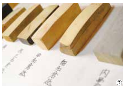
①下地研ぎは目の粗い砥石から細かい砥石に変えながら研いでいく ②8種類の砥石を使い分ける ③工程に合わせて砥石の形も変える ④使い込まれた研ぎの道具 ⑤仕上げ研ぎは繊細な作業が続く ⑥砥石を砕いた粒子で刃をこする
