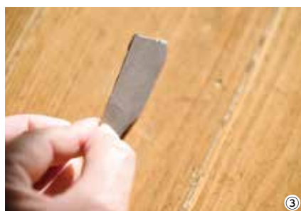
①下地研ぎは目の粗い砥石から細かい砥石に変えながら研いでいく ②8種類の砥石を使い分ける ③工程に合わせて砥石の形も変える ④使い込まれた研ぎの道具 ⑤仕上げ研ぎは繊細な作業が続く ⑥砥石を砕いた粒子で刃をこする
