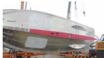
クレーンで船体を反転し船底を下にする
