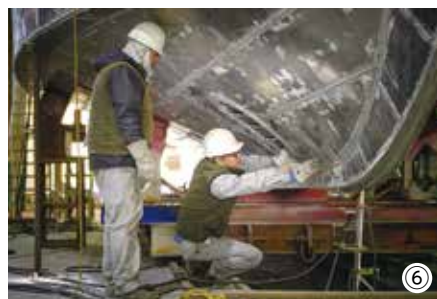
①巨大な工場で船を建造 ②ひと際目を引くロゴマーク ③設計図を作成 ④別の工場でウォーターカットしたアルミ軽合金の板(手前)と加工した板(奥) ⑤高い溶接技術がアルミ軽合金を使用した造船の要 ⑥船体の骨組みに外板を貼り付ける
