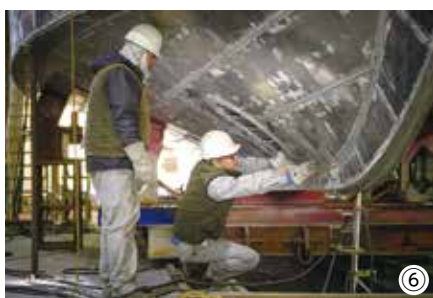
①巨大な工場で船を建造 ②ひと際目を引くロゴマーク ③設計図を作成 ④呉の工場でウォーターカットしたアルミ軽合金の板(手前)と加工した板(奥) ⑤高い溶接技術がアルミ軽合金を使用した造船の要 ⑥船体の骨組みに外板を貼り付ける
