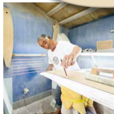
①サーフボードの素材に輪郭線を書く
